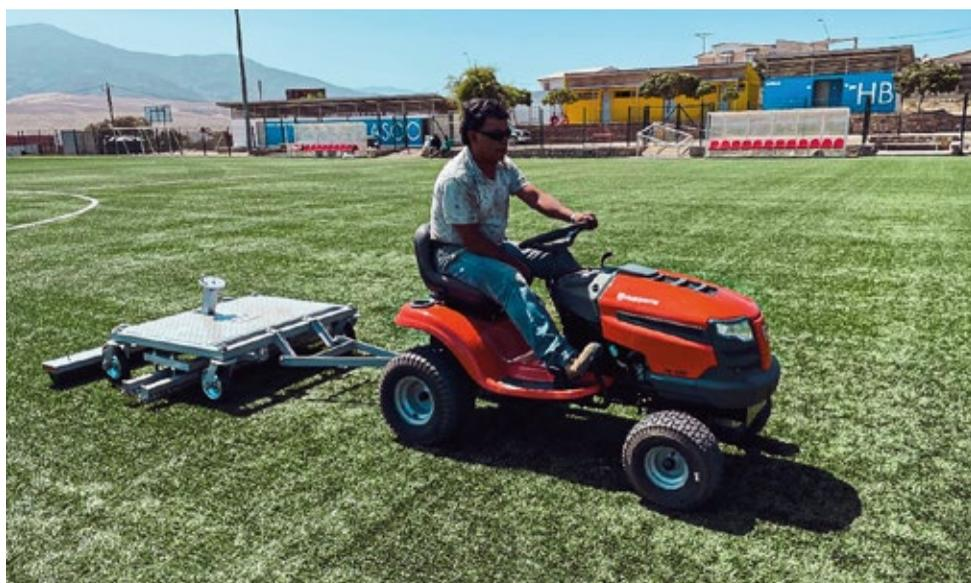
**Imagen N° 11** Mini tractor con asiento de respaldo y máquina descompactadora
